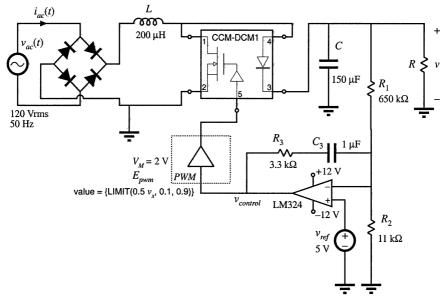
Fig. B.19 DCM boost rectifier example.
