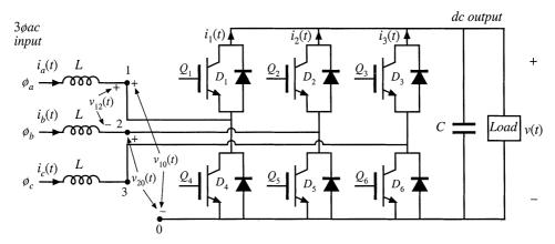
Fig. 18.39 Boost-type 3øac-dc PWM rectifier.
